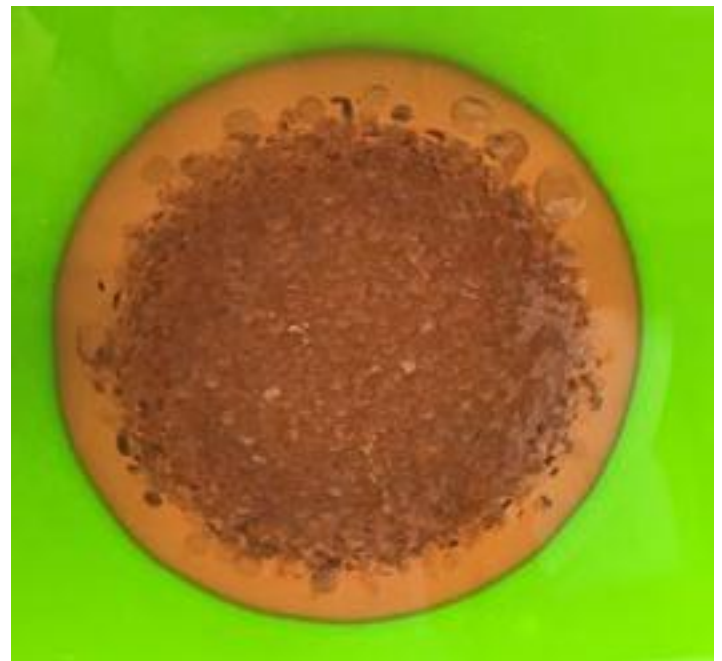
Bild 1: Widerstandsfähigkeit (Schutzgrenzbestrahlung) des Laserschutz-Fenstermaterials P1K10 gegen eine direkte Bestrahlung bei 1064 nm in Abhängigkeit des Belichtungsfleckdurchmessers, bestimmt für eine Belichtungsdauer von 150 Sekunden (Klassifizierung 105s (T2) nach EN 60825-4)
